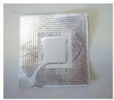
**Antitaccheggio integrato** - Optional per i cestini da 42 e 52 litri. Funziona con radiofrequenza 8,2 Mhz. Gli antitaccheggio vengono inseriti prima dell'assemblaggio con il manico e appena uscito dallo stampo a plastica ancora calda in modo da renderli parte del cestino. In questo modo si rende la rimozione impossibile.
